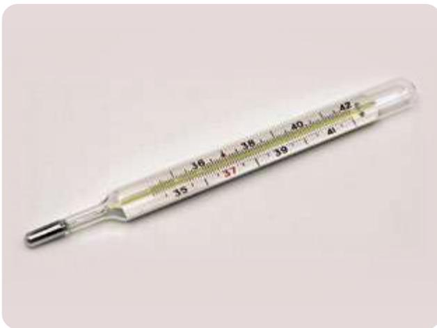
Los termómetros clínicos de vidrio de galio tienen una escala que va de 35 a 42 grados centígrados. El tubo interno es más estrecho en la parte inferior, de manera que impide el retorno del líquido termométrico al bulbo cuando se enfría. Por eso hay que sacudirlo para que vuelva a indicar una temperatura menor a 36 grados centígrados.
