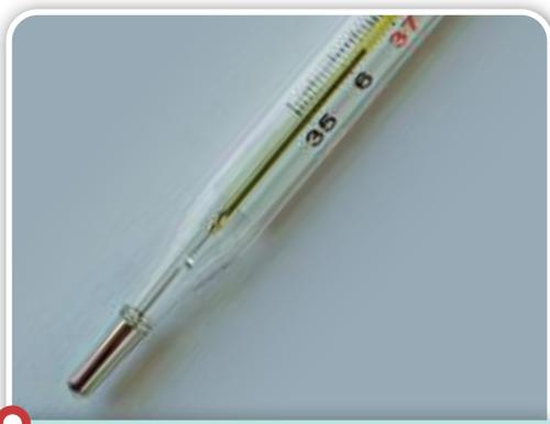
La altura del líquido indica un valor de temperatura en la escala detrás del tubo.
